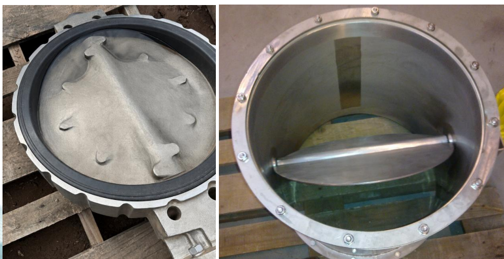
Figura 2 - Comparação entre uma válvula borboleta convencional (esquerda) e a Flow FlapValve (direita). Observa-se a vedação periférica comprimida na válvula convencional, inexistente na FFV.
